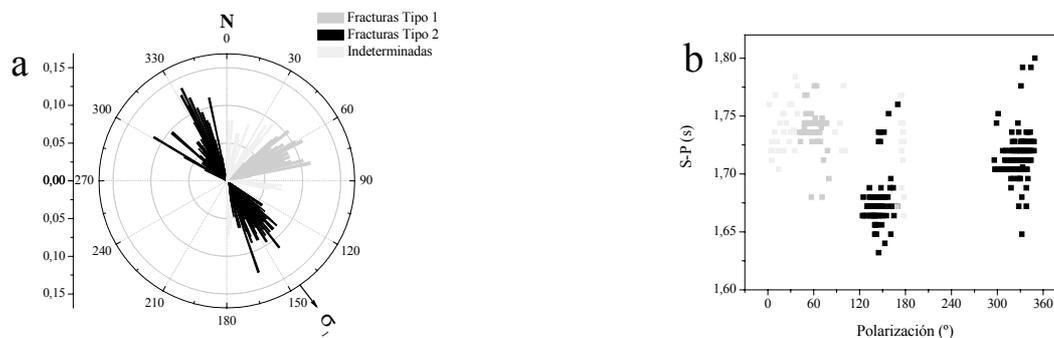
Figura3 a) Representación en diagramas rosa ( $\theta$ ,  $\rho$ ) de los parámetros anisotrópicos,  $\theta$  dirección azimutal de polarización y  $\rho$  el tiempo de retardo, b) s-p vs polarización los tres cúmulos indican la existencia de tres capas anisotrópicas a tres profundidades diferentes.
