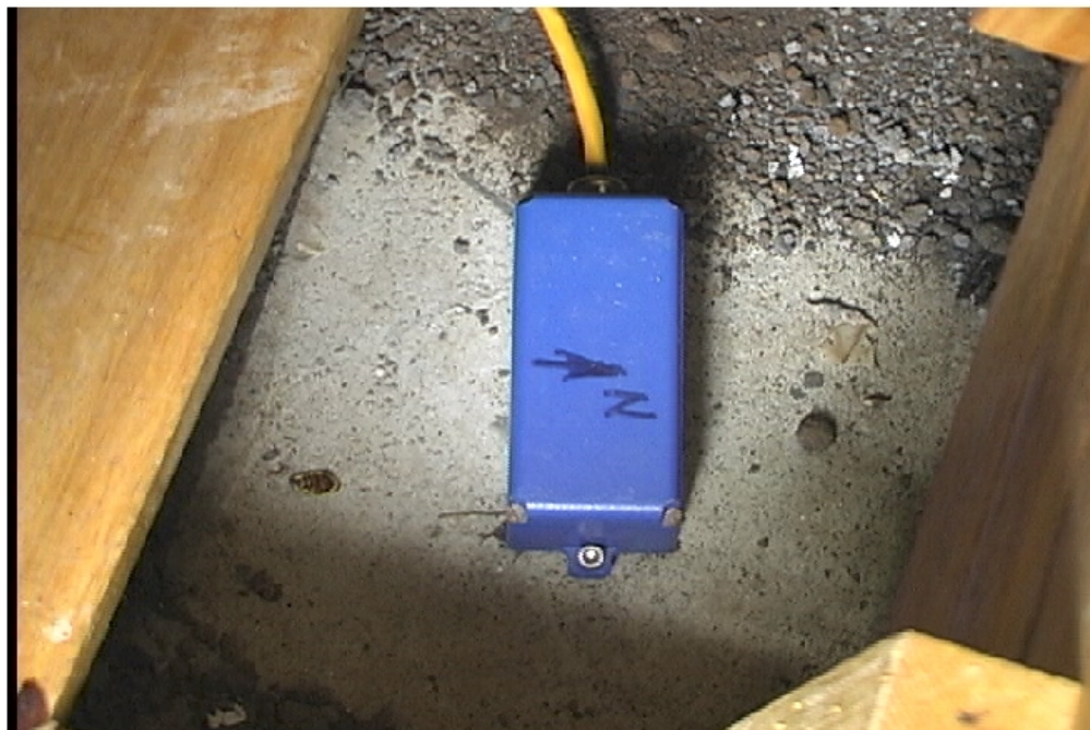
Figura 2.4. Sensor SSA-320 instalado en los equipos de adquisición GSR18 y GCR16
