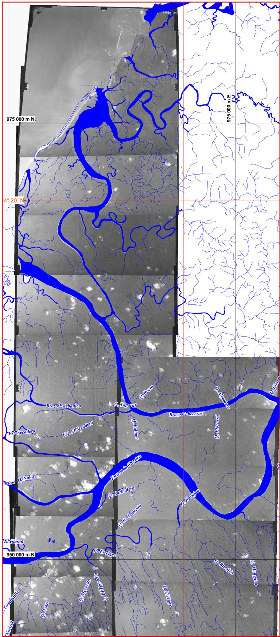
Sistema de coordenadas planas con base en proyección Gauss-Kruger Transversa de Mercator. Origen de coordenadas 77° 04' 51.30" de Longitud W y 4° 35' 56.57" de Latitud N, al cual se le asignaron las coordenadas planas 1'000.000 m E y 1'000.000 m N., respectivamente (IGAC Occidente); en color negro.
