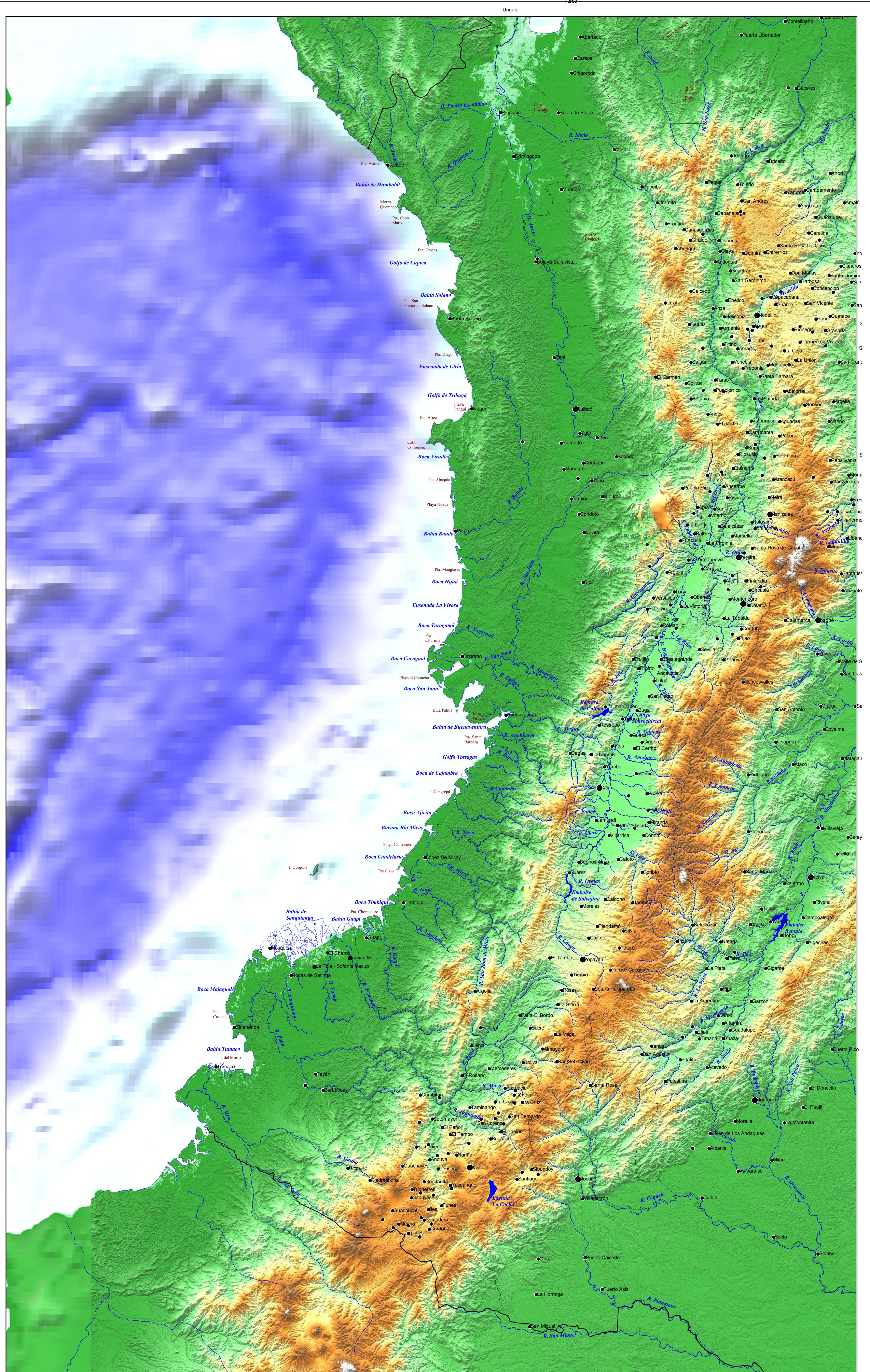
Sistema de coordenadas planas con base en proyección Gauss-Kruger Transversa de Mercator. Origen de coordenadas 77° 04' 51.30" de Longitud W y 0° 35' 56.57" de Latitud N, al cual se le asignaron las coordenadas planas 1'000.000 m E y 1'000.000 m N, respectivamente (IGAC Occidente); en color negro.
