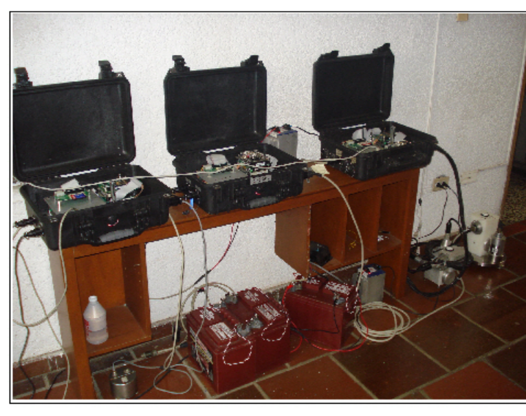
Sismógrafos digitales de tres componentes cada uno de 16 bits instalados en la red temporal para monitorear la sismicidad en cercanías de Buenaventura. Estaciones en el Alto Anchicaya, Calima y Bahía Málaga.
