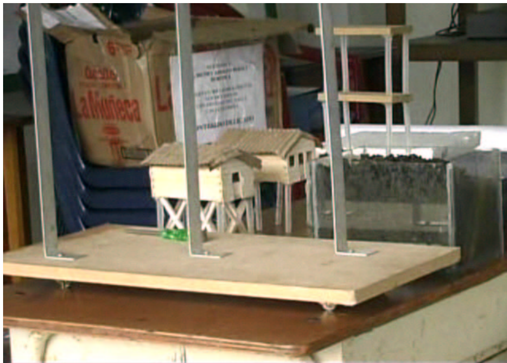
Foto1. Modelos didácticos para explicar la vibración del terreno (mesa sísmica), la licuación (cajas de arena) y el arriostramiento de viviendas (maquetas).
