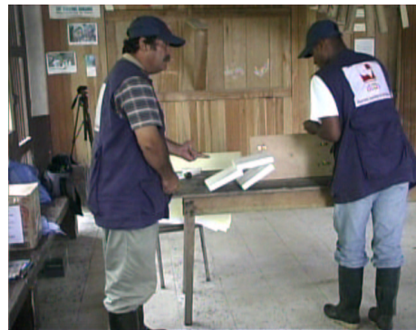
Foto 4. Ante un empuje lateral fuerte, la estructura pierde su estabilidad.
