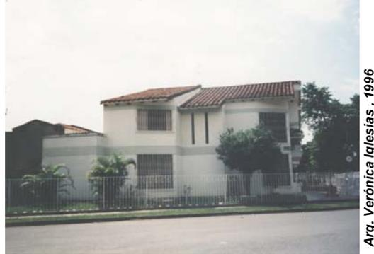
**Figura 20.** Vivienda en ladrillo, con cubierta de teja de barro, edificación relativamente pesada barrio Capri en la ciudad Cali.
