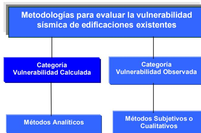
Figura 106. Metodologías para evaluar la vulnerabilidad sísmica.
