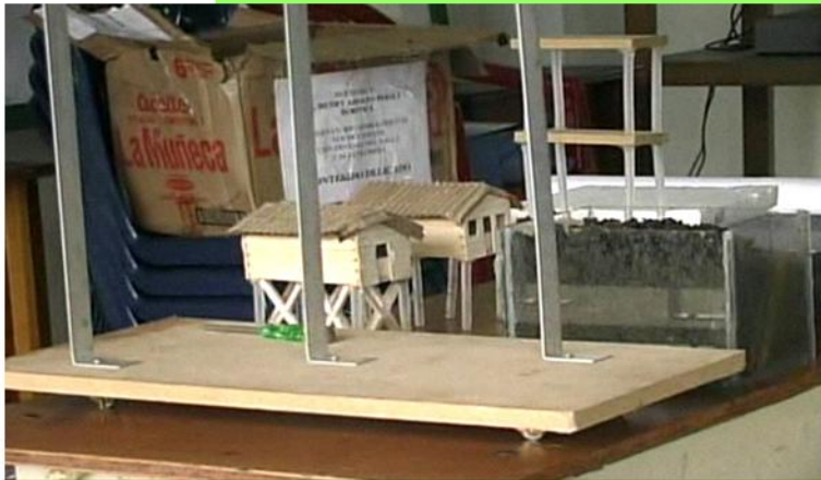
Modelos didácticos para explicar cómo vibran los diferentes tipos de suelo al paso de las ondas sísmicas
